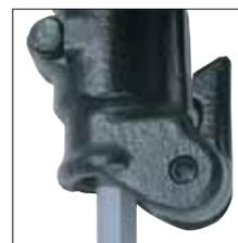
C = equipada com retentor de ferramenta do tipo roscado para uma operação mais confortável quando for necessário utilizar a máquina em tarefas na posição horizontal.
