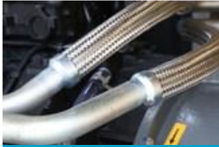
Mangueira de metal trançado para melhorar a segurança e a durabilidade.
