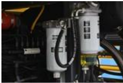
Filtro de combustível adicional como padrão para garantir a proteção do motor.
